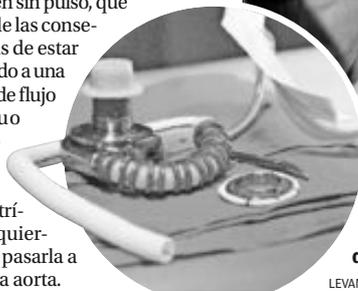
**El dispositivo mecánico que reemplaza la función de la parte izquierda del órgano.**
